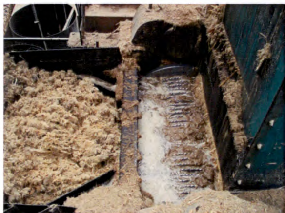
Fig.5 - Equipamento da fase de moagem
